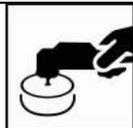
La poussière et les dégâts mineurs peuvent être polis après étuvage et séchage complet suivant les indications données ci-dessus, suivi d'un refroidissement de l'élément à température ambiante.
