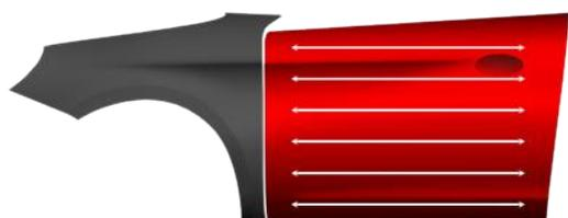
Préparer l'élément à réparer et l'élément à raccorder conformément à la Fiche Technique respective de l'Apprêt et de la qualité de Base mate Standox utilisés. Poncer l'Apprêt au P500-P600 à la machine. Poncer la zone de raccord au P1000-1200. Nettoyer la surface suffisamment avant l'application de la qualité de base mate Standox respective.
